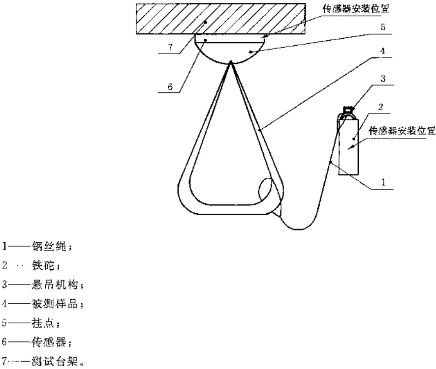
图 13 零部件的冲击负荷性能测试示意图
